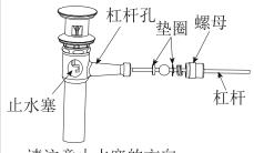
a. 请注意止水塞的方向。 b. 将杠杆经过杠杆孔,插 入到止水塞孔中,然后把 螺母旋紧。
