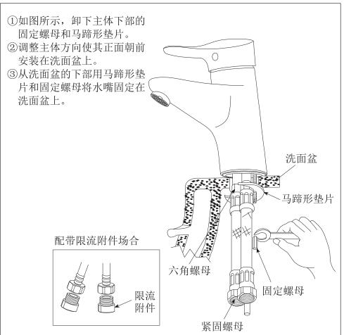
△注意:接入供水管前,务必确认紧固螺母内有无过滤垫片。
