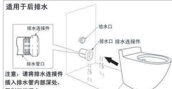
注意：请将排水连接件插入排水管内部深处，否则可能漏水。
