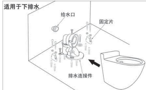
按照图示顺序用螺丝固定排水连接件和固定片。然后将陶瓷平推与给水口和排水连接件连接同时套住固定片。
