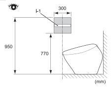
● 暂时安装在步骤 32 中所决定的位置后,请确认Ⅰ-1的收信状态。
