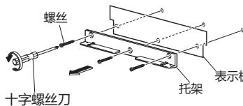
4. 用螺丝将托架安装到墙面
