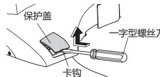
2) 用一字型螺丝刀松开进水过滤装置后拉出
