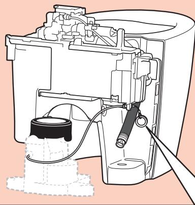
① 将绳子穿过固定台的缝隙部位
