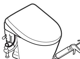
※本产品禁止使用任何水泥安装, 对所有因水泥安装引起的坐便器破裂本公司恕不负责。
