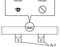
此时,如果小便器(A-1)没有达到规定高度,可拧松后背吊钩(A-7)的木螺钉(A-8),在与墙壁之间塞入金属片进行调整。/
