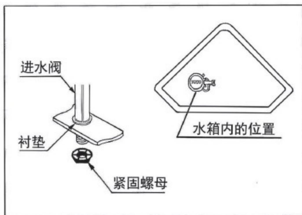
注意：紧固螺母若拧的过紧，可能会破损并导致漏水。
