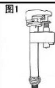
将进水阀套上锥形垫后，穿过水箱中进水阀安装孔，拧紧紧固螺母，见图1。
