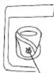
通过调节浮杆改变浮桶高度，来控制水位线高低。（+表示水位线升高水量增加，-表示水位线降低水量降低。）见图2
