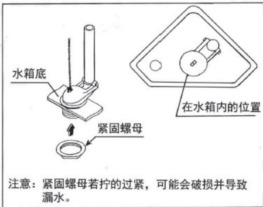
注意：紧固螺母若拧的过紧，可能会破损并导致漏水。
