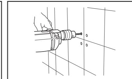
注3：必须安装厚度60mm以上的加固木。厚度不满足60mm的情况，扶手会脱落，墙体会破坏。
