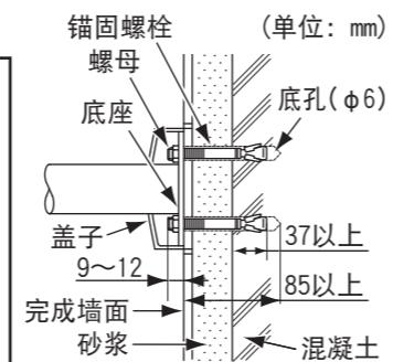
注2：锚固螺栓埋入混凝土的埋入量37mm以上。不满足37mm的情况，扶手会脱落，墙体会破坏。
