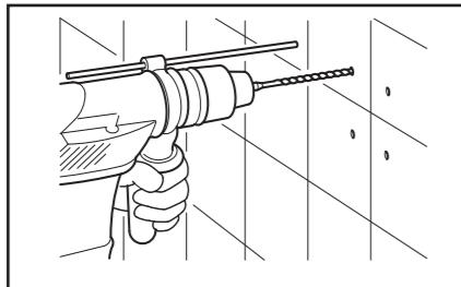
注1：在混凝土上，请使用Φ6mm，深85mm以上的开孔钻头，钻头的直径过大，偏心大，扶手不能牢固地固定。
