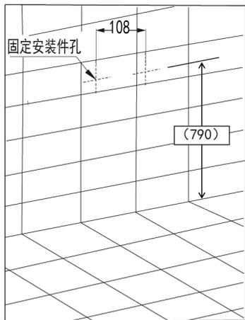
4-2-2. 将洗手盆放到安装位置，用水平尺矫正水平位置后，用笔在墙面上标出陶瓷安装孔的位置。
