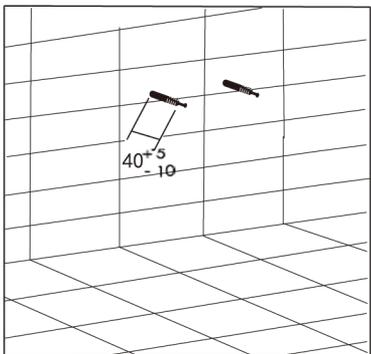
按照左图所示，放入固定螺栓，并将外露的铁钉垂直敲入固定螺栓内。
