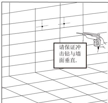
**注意：**根据描好的2个点，在墙面上垂直打孔。
