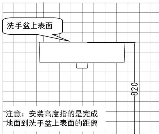
4-2-1. 按照下图给出的尺寸首先确定固定螺栓的位置
