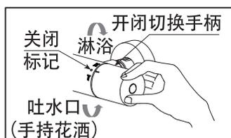
3. 若将开闭切换手柄向自身方向旋转，从吐水口(手持花洒)中出水。若向后旋转，则从淋浴器中出水。旋到极限位置时，出水量达到最大。欲止住吐水，请将开闭切换手柄的标线对准本体的关闭标记。
