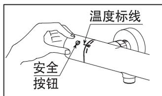
2. 设有安全按钮，以防误操作而喷出热水。温度调节手柄被固定在“40”附近。若想进行高温出水(>40℃)，必须按下安全按钮，同时，旋转手柄。
