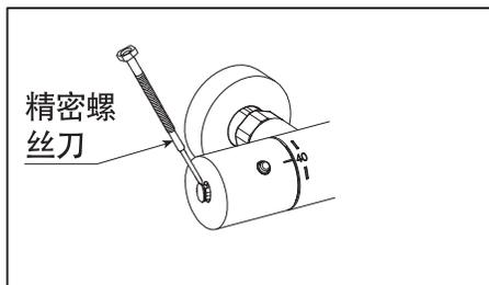
2. 拔出温度调节手柄时，请先取出表示盖，拧下小螺钉。取表示盖时，请用螺丝刀等尖部比较细的东西，注意不要把镀层表面划伤，不要使调节手柄旋转。
