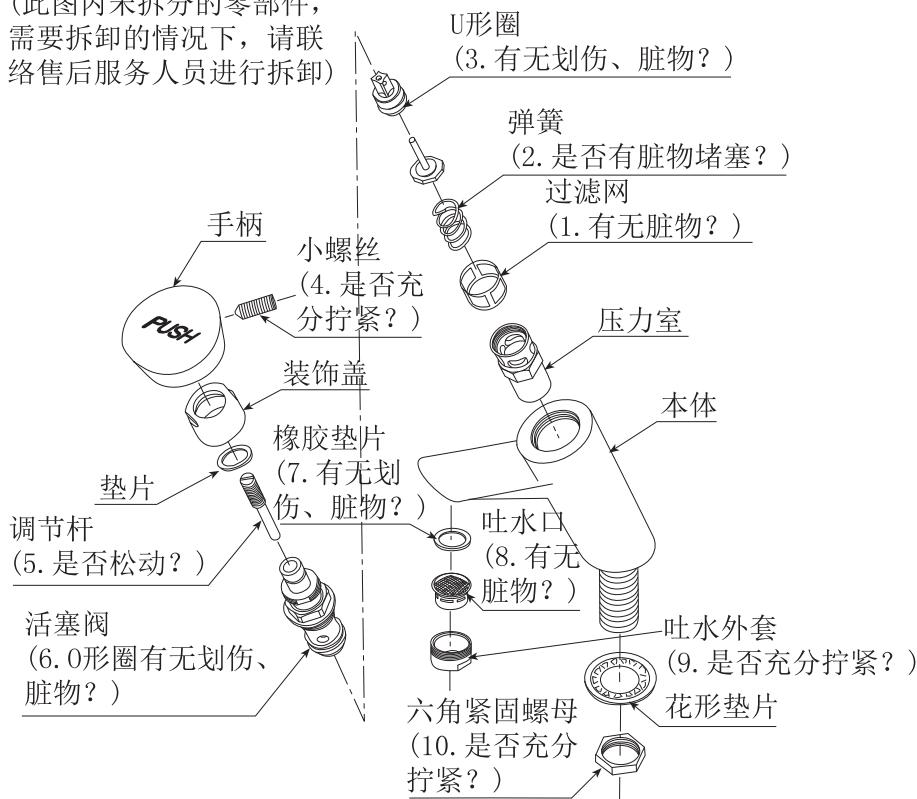
※拆卸检查后, 安装时请注意弹簧上的针不允许弯折,
