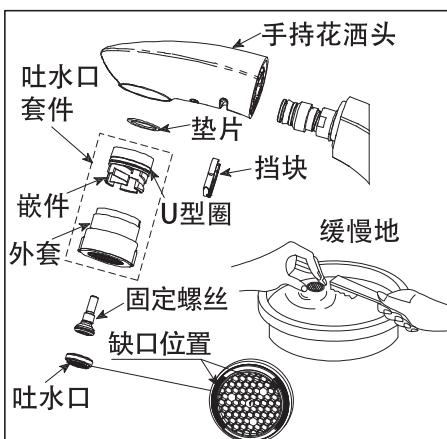
**注意：**a. 嵌件上有U型圈，注意不要拆下来，以免划伤，把吐水口套件组装回去时，请注意不要让U型圈外翻，一边逆时针旋入一边用指甲压U型圈边缘，直到U型圈完成进入即可。
