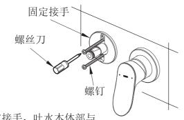
b. 将装饰盖穿过固定接手, 吐水本体部与固定接手连接, 使其与装饰盖完全贴紧, 调整好装饰盖与吐水本体位置后, 将吐水本体用螺钉紧固。
