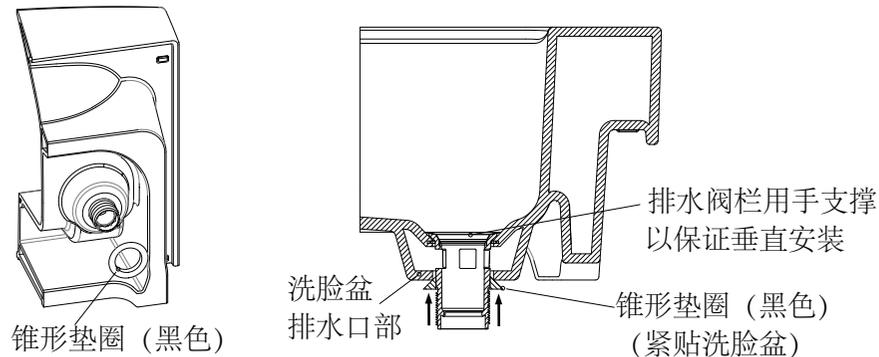
然后将防滑垫圈和螺母安装到排水阀栏上
