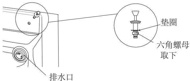
从洗脸盆底面将拆下的六角螺母和垫圈安装至排水金具开关上。
