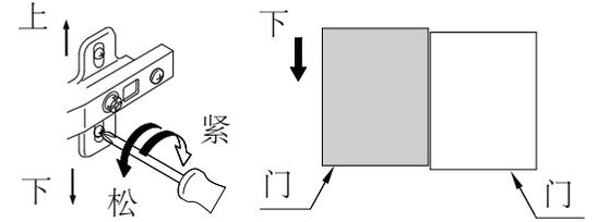
拧松螺丝后，上下移动铰链调整门板高低位置
