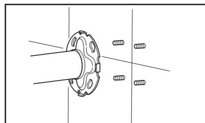
将建议在安装孔周围涂布硅胶。
