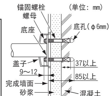
注2：锚固螺栓埋入混凝土的埋入量37mm以上。不满足37mm的情况，扶手会脱落，墙体会破坏。
