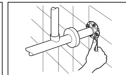
将建议在安装孔周围涂布硅胶。
