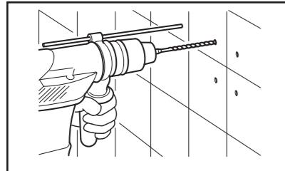
注1：在混凝土上，请使用Φ6mm，深85mm以上的开孔钻头，
