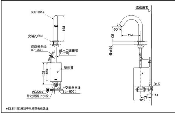
DLE110AS+DLE414DSKS/DLE414DES 分体型自动感应水龙头(恒温型)
