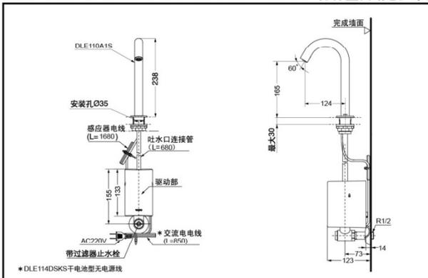
DLE110A1S+DLE414DSKS/DLE414DES 分体型自动感应水龙头(恒温型)
