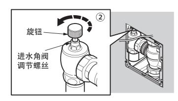
由于定流量阀的特性所致,在一些现场的设置水压下,会发出脉动声音,属于正常现象。如果觉得不适,可通过拧小进水角阀减小声音。
