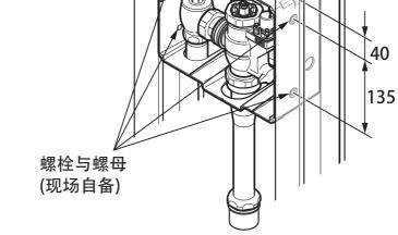
【固定在背面墙上(混凝土)上】 在外壳背面开孔,用锚栓与螺母(现场自备) 固定在指定位置。
