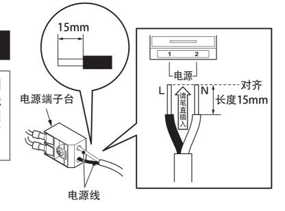
• 将电源线的线芯留出相同的 长度(在露出电源端子台部 分的长度也请加工成一致。)
