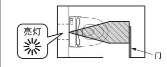
※感应器如果感应到墙壁或门,则感应人体功能无法正常使用,不能进行大小冲洗的识别和自动冲洗。
