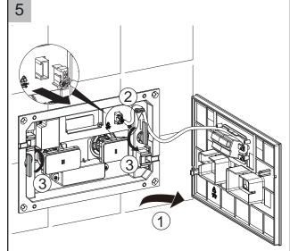
取下玻璃面板,拔出连接在玻璃面板上的接线,旋转支架盖上的固定杆。
