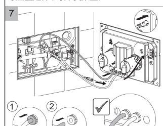
检查支架盖后的电源线和气管是否正常连接,若有脱落、连接不紧密现象,请重新连接好。注意拔气管时要先压下接头的蓝色塑料圈,同时向外拔出气管.
