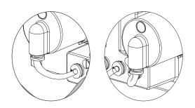
检查支架盖与气囊间气管是否正确连接,若有脱落、连接不紧密现象,请重新将气管连接好。
