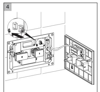
确认连接的线路是否正确,需要时请重新插拔以使线路OK;
