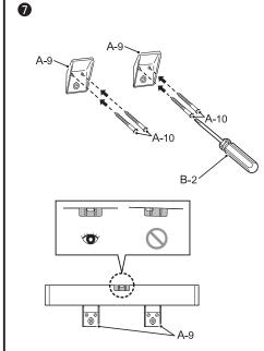
此时,如果小便器(A-1)没有达到规定高度,可拧松后背吊钩(A-9)的木螺钉(A-10),在与墙壁之间塞入金属片进行调整。/
