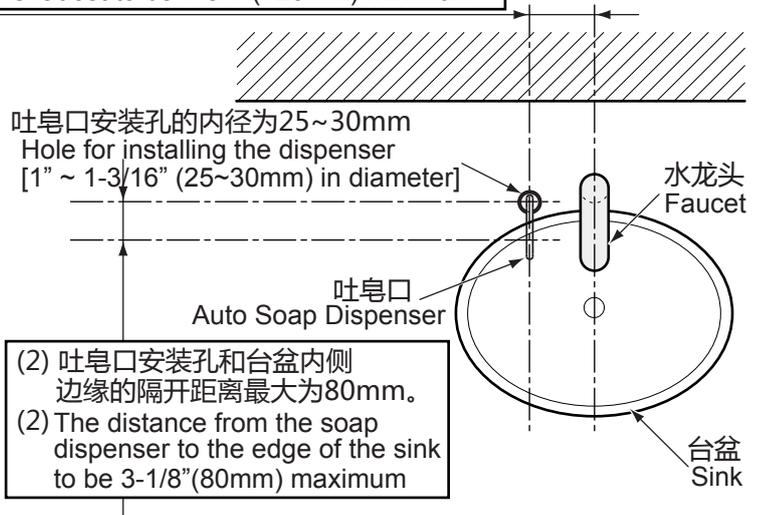
(2) 吐皂口安装孔和台盆内侧边缘的隔开距离最大为80mm。
