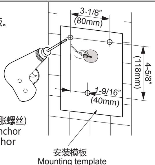
4.将自攻螺丝插入上方的两个螺丝孔内，
