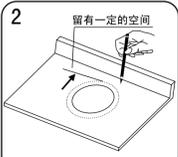
根据安装用纸样定位洗面器的安装位置，用笔沿洗面器安装用纸样的边缘将洗面器的轮廓与安装孔描绘在台面上。
