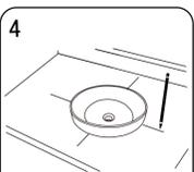
将洗面器放入已经切割好的安装孔内，确定位置，检查间隙，并做好定位记号。
