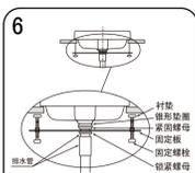
将排水管插入排水口，装上锥形垫圈和紧固螺母，拧紧螺母。从台面下依次装上固定板和锁紧螺母，用手将固定螺栓往上拧，在螺栓头部装上衬垫，衬垫顶到台面不松动即可，切勿用力过猛，以免损坏台面。
