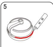
检查完毕后，将洗面器倒置，在洗面器反面边缘的凹槽中涂上硅胶之类的密封材料。再把洗面器小心的放入安装孔中，并跟先前的记号对准再紧紧的压下。
