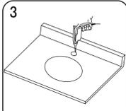
根据安装用纸样中使用方法确定出洗面器在台面上的安装位置和切割线。并根据安装的龙头与台面尺寸，正确切割龙头安装孔。
