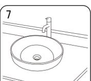
等密封材料硬化后，将龙头按照其说明书上的要求指示安装到台面上。
