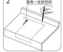
的安装位置,用笔根据台面 安装用纸样的边缘将台面开 槽轮廓描绘在台面上。
