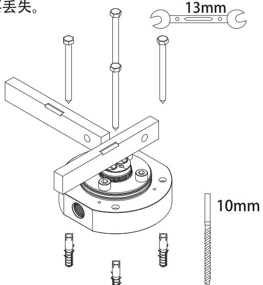
※本体的吐水口方向为台座接头上的红色表示相反方向。浴缸设定位置确认后，大致的设置方向决定后再对台座进行固定。※龙头本体固定的时候，吐水口的方向也可以调整。
