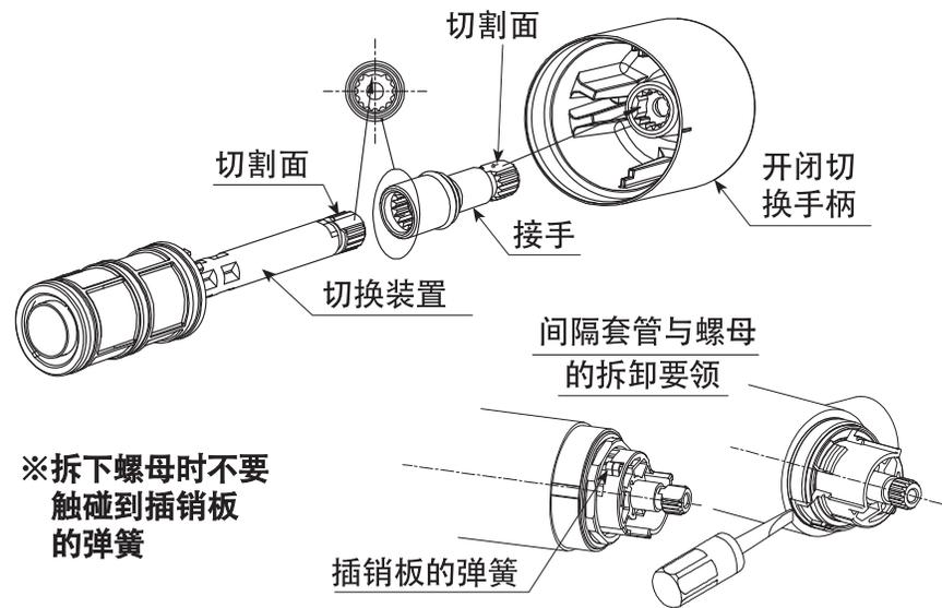
※无法拆下间隔套管时，请将螺丝刀插入切口部。
