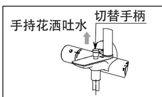
4. 当吐水口为吐水状态时，向上提拉切替手柄，则会变更为手持花洒吐水，停止吐水时，切替手柄会自动复位。(※此套制品使用的是自动复位切替阀芯，如欲从手持花洒吐水变更为吐水口吐水，请先关闭开闭切替手柄之后再打开即可，尽量避免按压切替手柄。)
