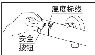
2. 设有安全按钮，以防误操作而喷出热水。温度调节手柄被固定在“40”附近。若想进行高温出水(>40℃)，必须按下安全按钮，同时，旋转手柄。
