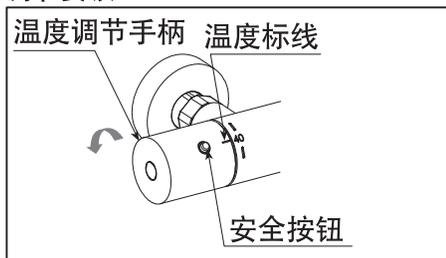
1. 让花洒吐水，旋转温度调节手柄直至出水温度达到 $40^{\circ}\text{C}$ ，该位置与本体上的刻度无关，旋转至高温侧时，请按安全按钮。
