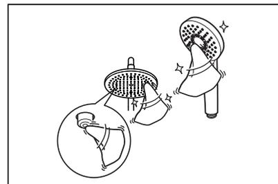
若使用时出现水线不均匀的现象，可用毛巾轻轻擦拭散水板上的小硅胶吐水口，清除异物。
