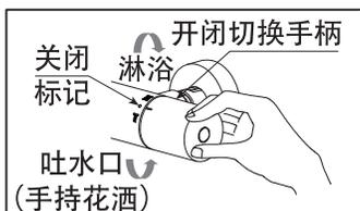
3. 若将开闭切换手柄向自身方向旋转，从吐水口(手持花洒)中出水。若向后旋转，则从淋浴器中出水。旋到极限位置时，出水量达到最大。欲止住吐水，请将开闭切换手柄的标线对准本体的关闭标记。
