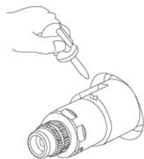
间隔套管螺母的拆卸要领
