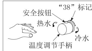
旋转温度调节手柄，将吐水温度调节至期望的热水温度。刻度“38”表示热水温度的标准。
