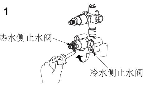
用平口螺丝刀关闭冷、热
