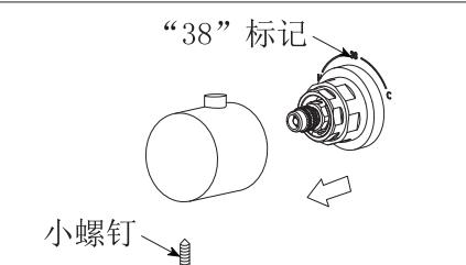
将温度调节手柄上的安全按钮和本体上的“38”标记相对齐(部分产品“38”标记在手柄上, 板上印记为“◎”或其它形状印记), 将温度调节手柄装上, 拧紧小螺钉。
