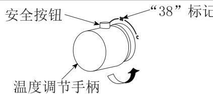
让吐水口吐水, 旋转温度调节手柄直至出水温度达到38°C的位置处, 此时安全按钮位置与装饰板上“38”刻度无关。(旋转至高温侧时, 请按安全按钮。)
