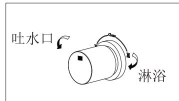
将切换手柄向左旋转时吐水口吐水，向右旋转时则从淋浴器中出水，向左右旋转至头时，出水量达到最大。旋转到中间时为关闭状态。
