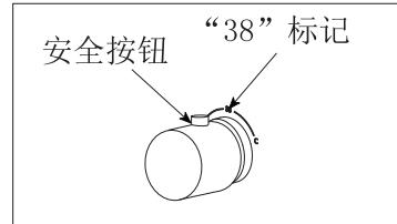
设有安全按钮，以防误操作而喷出热水。温度调节手柄被固定在“38”附近。若想进行高温出水( $>38$ )，必须按下安全按钮，同时，旋转手柄。
