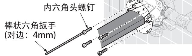
⑥再用L型六角扳手完全旋紧固定。
