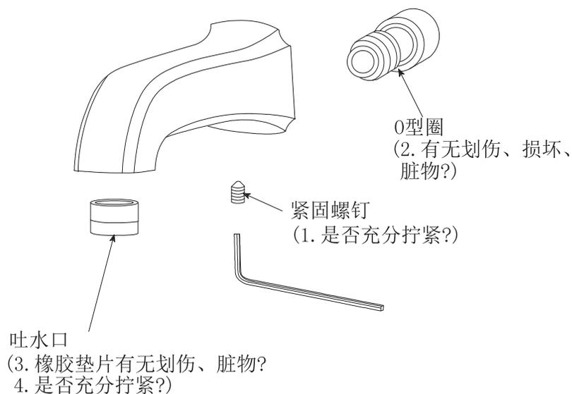
※不同示例产品的拆卸与原理基本相同。
