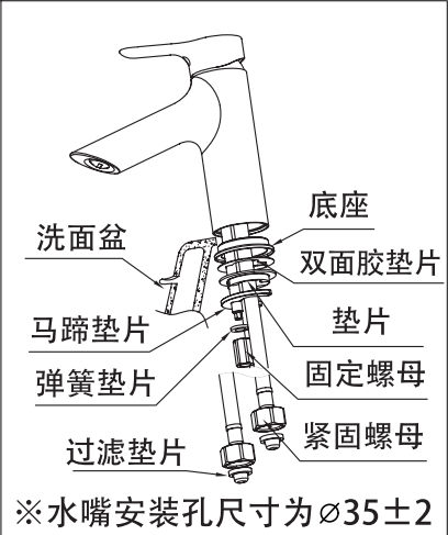
图1(水嘴主体的安装)
