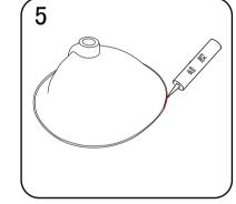
检查完毕后,将洗面器倒置 后,在洗面器反面边缘的凹 槽中涂上硅胶之类的密封材 料。再把洗面器小心的放入 安装孔中,并跟先前的记号 对准再紧紧的压下。
