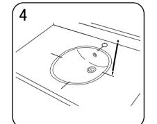
将洗面器放入已经切割好 的安装孔内,确定位置, 检查间隙,并做好定位记
