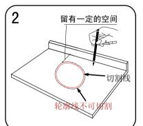
根据安装用纸样定位洗面器 的安装位置,用笔将洗面器 的轮廓与切割线描绘在台面
