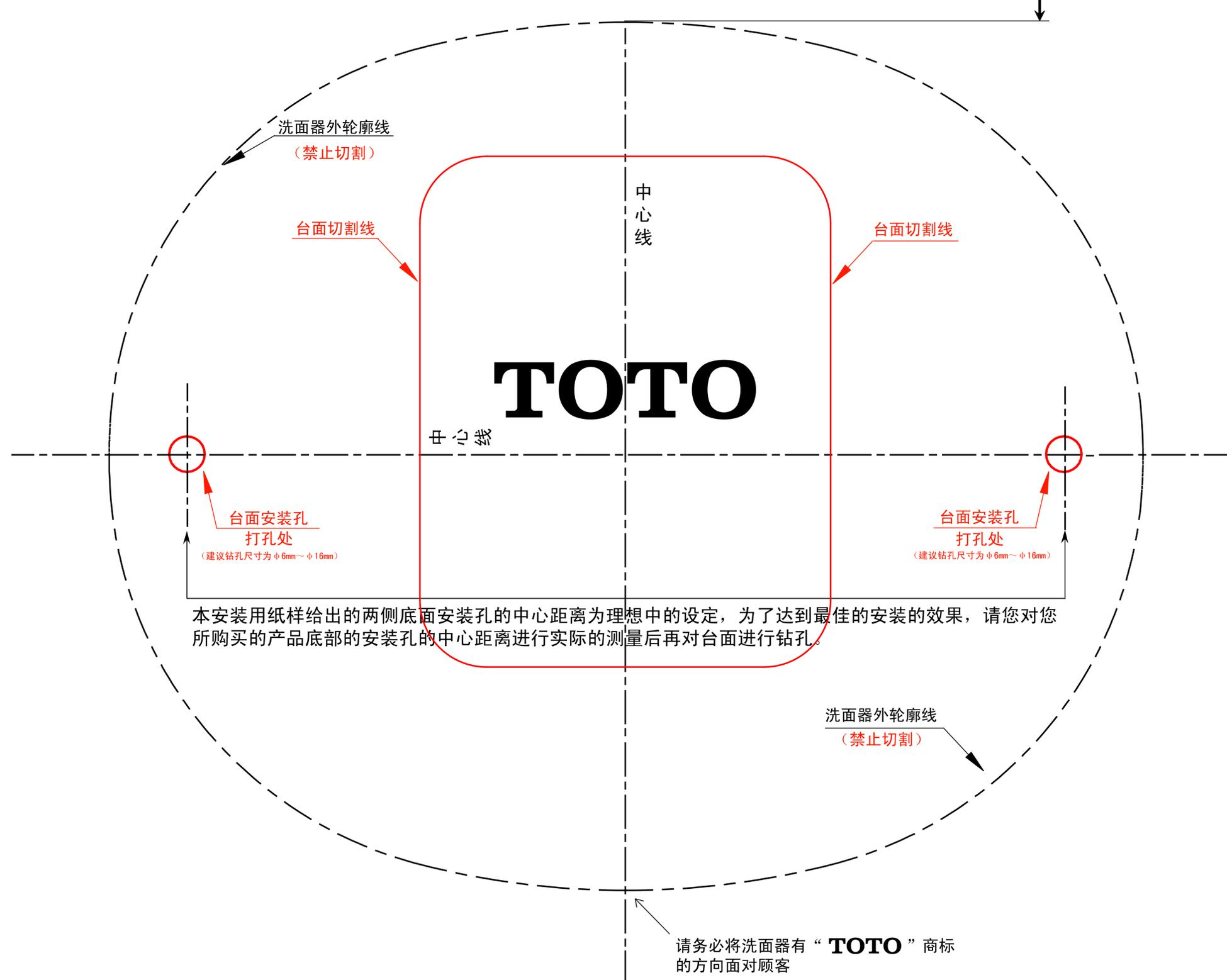
本安装用纸样给出的两侧底面安装孔的中心距离为理想中的设定，为了达到最佳的安装的效果，请您对您所购买的产品底部的安装孔的中心距离进行实际的测量后再对台面进行钻孔。
