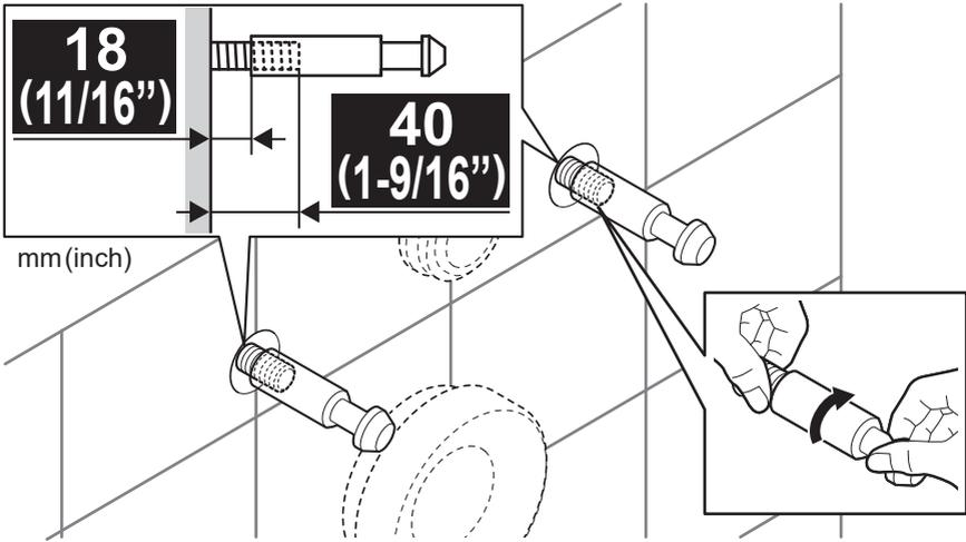
使用缓冲材时 / When using a sound insulation mat /
