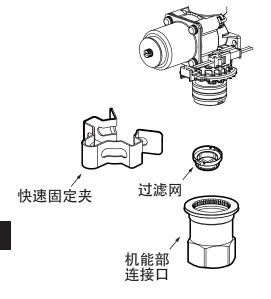
关闭进水角阀后,再取下过滤网盖子。
