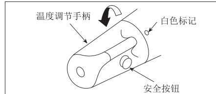
让吐水口吐水，旋转温度调节手柄直至出水温度达到38°C的位置处，该位置与手柄上的刻度无关。(旋转至高温侧时，请按安全按钮。)
