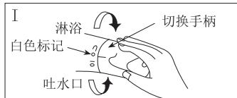
若将切换手柄向自身方向旋转，便从吐水口中出水。若向后旋转，则从淋浴器中出水，旋到头时，出水量达到最大。欲止住吐水，请将切换手柄的标线对准白色标记。
