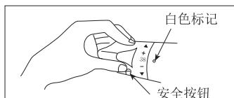
设有安全按钮，以防误操作而喷出热水。温度调节手柄被固定在“38”附近。若想进行高温出水( $>38$ )，必须按下安全按钮，同时，旋转手柄。
