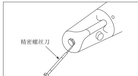
拔出温度调节手柄时，请先取出表示盖，拧下小螺钉。
