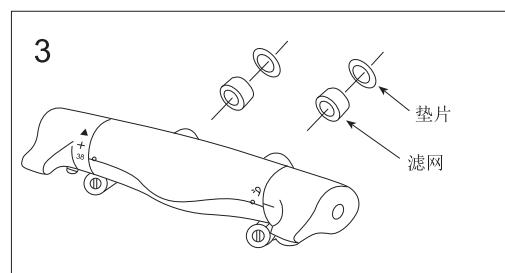
由于本体里装有滤网，所以请把滤网拆卸下来，进行清洗，然后，按照上述2、1的顺序进行安装。
