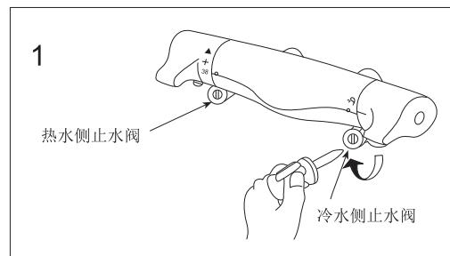
用平口螺丝刀关闭冷、热水侧的止水阀。
