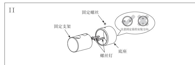
② 安装底座时，在安装孔对应的墙面上钻两个孔，两个孔的中心线必须在一条水平线上，将膨胀管打入墙上的孔内，然后用螺丝钉将底座固定到墙上。（注意先确定底座的具体的安装位置）
