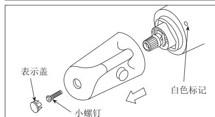
将温度调节手柄上的“38”和本体上的白色标记相对齐，将温度调节手柄装上，拧紧小螺钉，装上表示盖。
