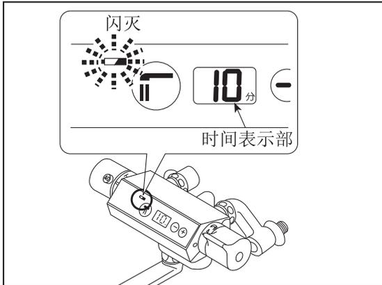
当电池电量不足时，开闭按钮旁边的电量显示标志变红并闪灭，此时请更换电池。使用电池为2节5号碱性电池。根据使用环境不同，电池电量不足时，标志不显示情况也有。如果按动开闭按钮出水后立即止水，则表示电量不足，请更换电池。电池电量使用完了时，时间显示器显示“LO”，相关功能也不能使用。
