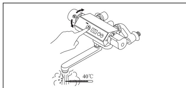
(4) 确认出水温度是 $40^{\circ}\text{C}$ 后，拧紧小螺钉装上表示盖。
