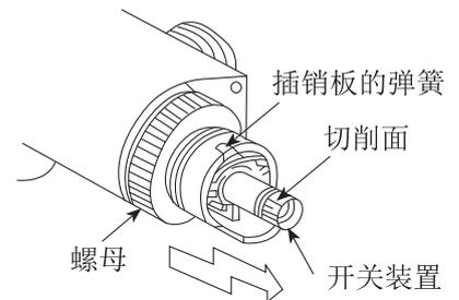
※拆下螺母时不要触碰到插销板的弹簧
