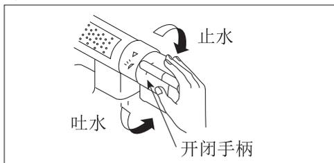
若将开闭手柄向自身方向旋转，便从身体冲浴花洒吐水。旋到头时，出水量达到最大，若向后旋转则关闭。
