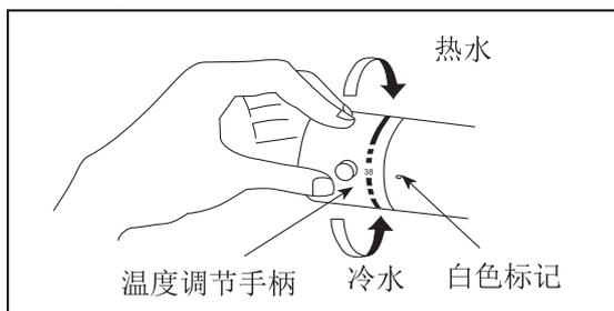
旋转温度调节手柄，将期望的出水温度调节至白色标记处。标识“ ”表示出水温度的标准。
