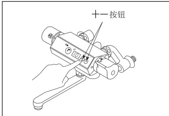
吐水口止水状态下按动十一按钮，可改变吐水时间设定。
