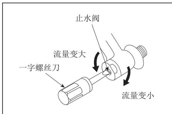
3. 将温度调节手柄安全按钮按住向上旋到最大(热水侧)按2所述内容调节热水流量。
