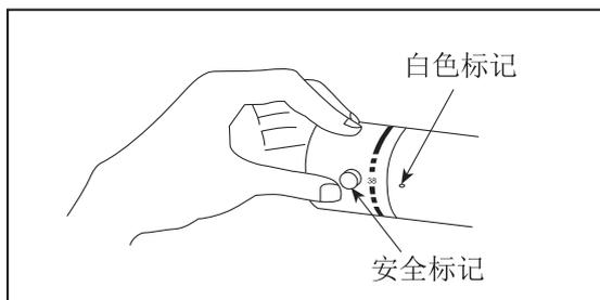
设有安全按钮，以防误操作而喷出热水。温度调节手柄被固定在“ ”附近。若想进行高温出水 ( $> 42^{\circ}\text{C}$ )，必须按下安全按钮，同时，旋转手柄。
