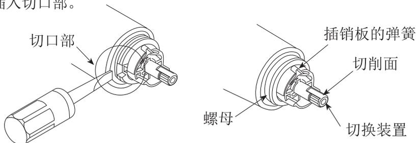
※拆下螺母时不要触碰到插销板的弹簧。
