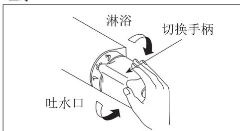
若将切换手柄向自身方向旋转，便从吐水口中出水。若向后旋转，则从淋浴器中出水。旋到头时，出水量达到最大。
