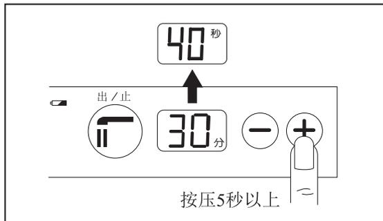
止水状态下将时间显示器上的数值升到30分，放开按钮。持续按+按钮5秒以上，可以设定30分钟以上吐水。从30分钟以上向下减的时候要按上述操作再做一次即可。
