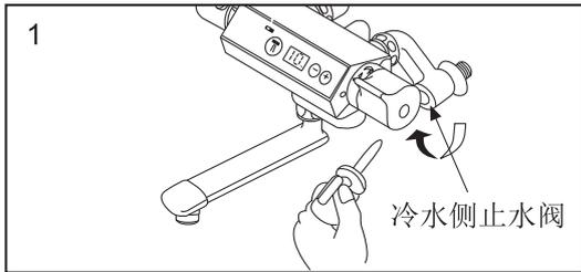
用平口螺丝刀关闭冷、热水侧的止水栓。
