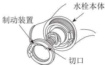
※制动装置要对准器具本体的缺口插入。
