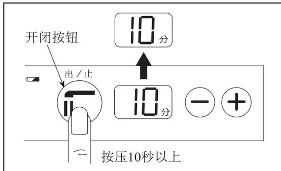
止水状态下按开闭按钮持续10秒以上，所设定的时间值不能再作变动。同样的操作再作一次，时间又恢复到可以变动的状态。
