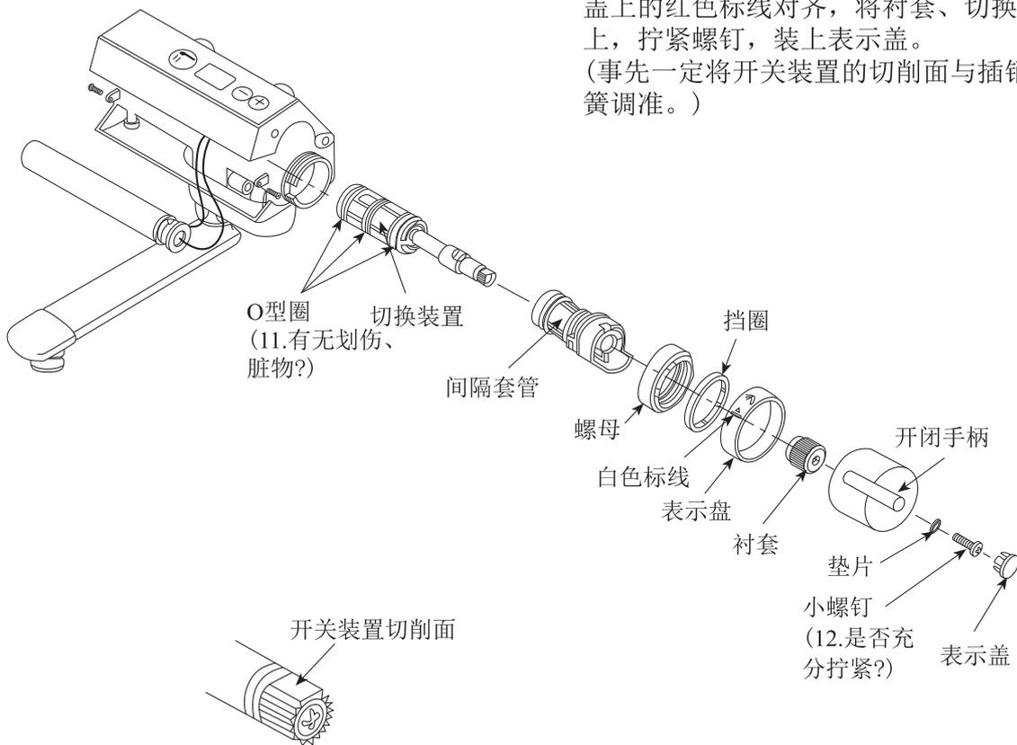
事先将开关装置切削面朝上。
