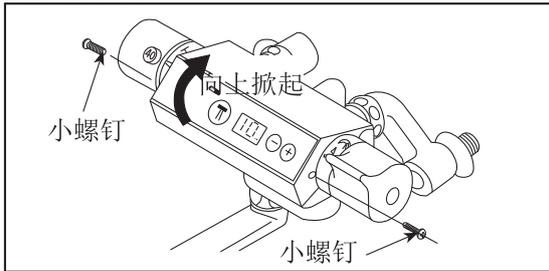
1. 将上盖两侧螺钉旋下后向上掀起上盖。
