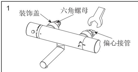
先关闭冷热水进水开关。
