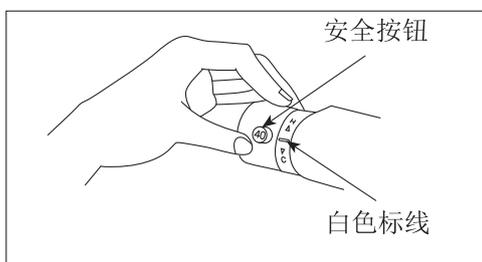
设有安全按钮，以防误操作而喷出热水。温度调节手柄被固定在“40”附近。若想进行高温出水(>40°C)，必须按下安全按钮，同时，旋转手柄。注意：用完后，必须将手柄返回标识40以下，以防下次使用时被烫伤。
