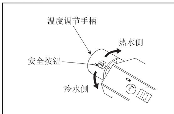
1. 将温度调节手柄向下旋到最大(冷水侧)，按开始按钮。
