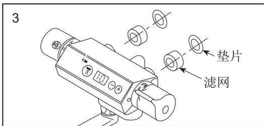
由于本体里装有滤网，所以请把滤网拆卸下来，进行清洗，然后，按照上述2、1的顺序进行安装。
