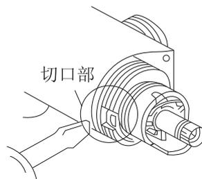
※无法拆下间隔套管时，请将螺丝刀插入切口部。
