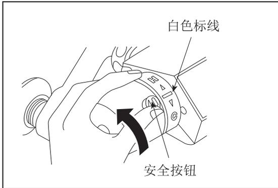
设有安装按钮，以防误操作而喷出热水。温度调节手柄被固定在“40”附近。若想进行高温出水(>40℃)，必须按下安全按钮，同时，旋转手柄。
