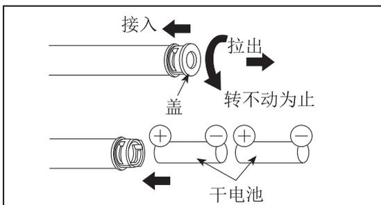
3. 将电池盒盖拉出，取出并更换电池后，将电池盒盖安装上。
