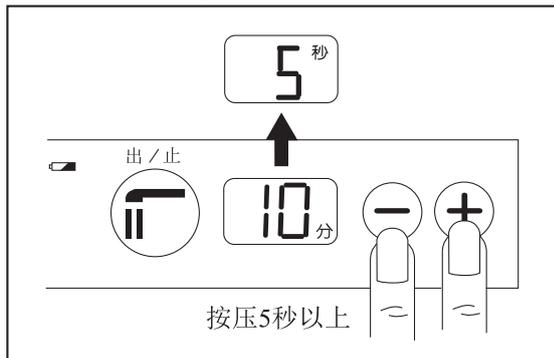
止水状态下十一两个按钮同时按压3秒以上，显示器上显示数字为5秒，再按压十一按钮可以改变秒数。返回到分的设定时也同样将两个按钮同时按3秒以上，即可返回到分的设定。
