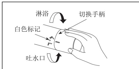
若将切换手柄向自身方向旋转，使从吐水口中出水。若向后旋转，则从淋浴器中出水。旋到极限位置时，出水量达到最大。欲止住吐水，请将切换手柄的标线对准本体的白色标记。
