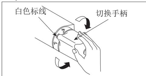
欲止住吐水，请将切换手柄的标线对准白色标线。
