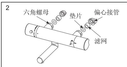
从偏心接管中取出滤网，进行清洗，然后按照 、 顺序进行安装。
