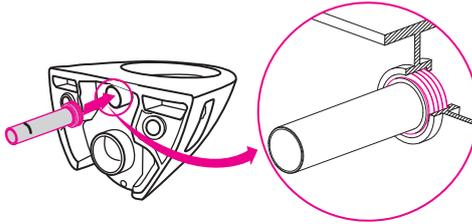
密封套安装时连同冲刷直管一起插入马桶孔内。
