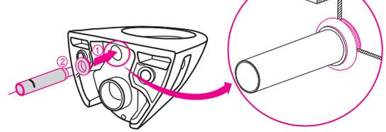
密封套B安装:①首先须将密封套装入马桶孔;
