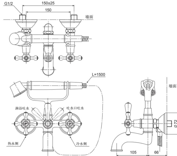
注: 冷热水侧手柄开闭角度90°
